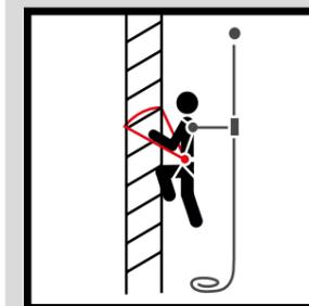
La naturaleza de la mayoría de los trabajos en sujeción (Posicionamiento) EN358 requiere de arnés anticaídas EN361, por lo que se recomienda la combinación de ambos (Árnés anticaídas con cinturón de posicionamiento) para trabajos de este tipo.
