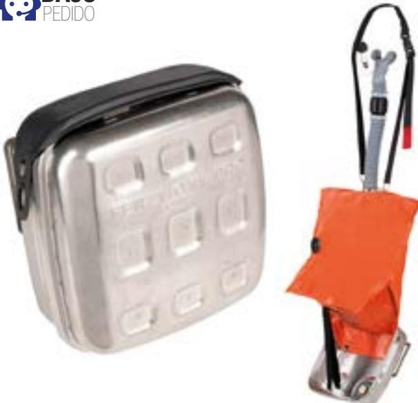
Oxy-Pro es un aparato de evacuación de circuito cerrado con un tiempo de servicio prolongado que utiliza superóxido de potasio para regenerar el aire exhalado. De conformidad con la norma EN 13794, está recomendado para la evacuación de emergencia en entornos de alto riesgo, como el tratamiento de aguas y los trabajos en espacios confinados.
