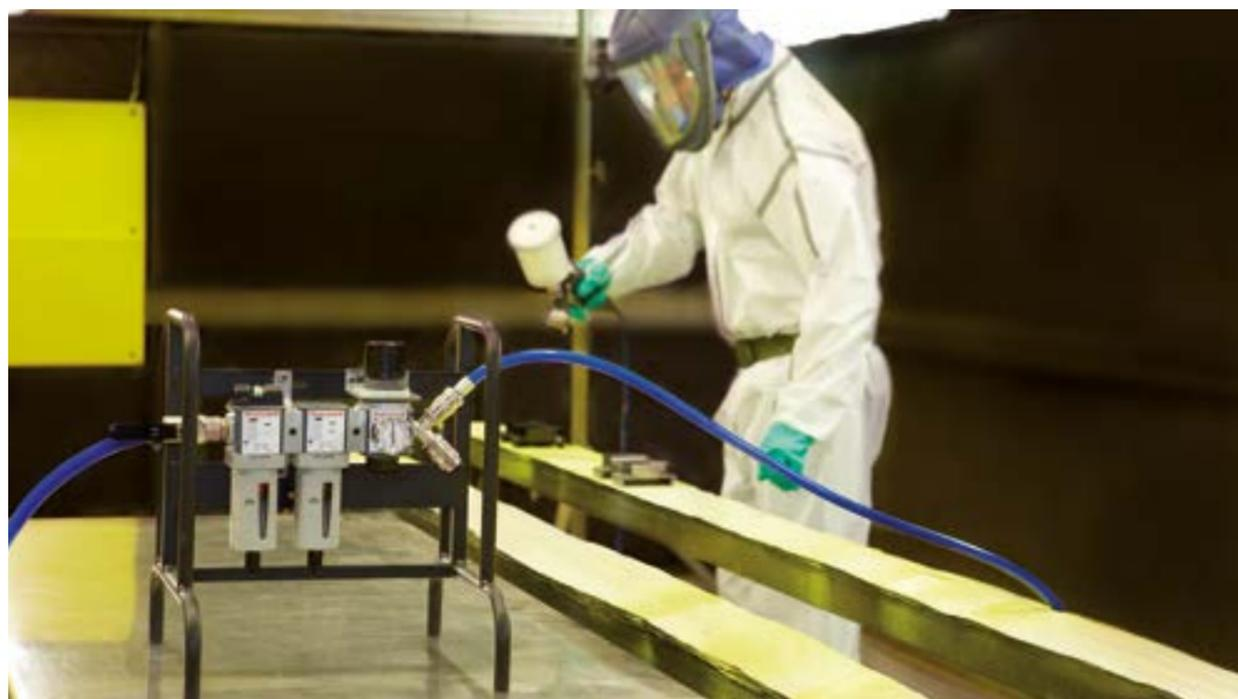
Las estaciones de filtrado deben ser utilizadas solamente con sistemas industriales de aire comprimido. El aire que alimenta al equipo debe ser de calidad respirable conforme a Norma EN12021.
