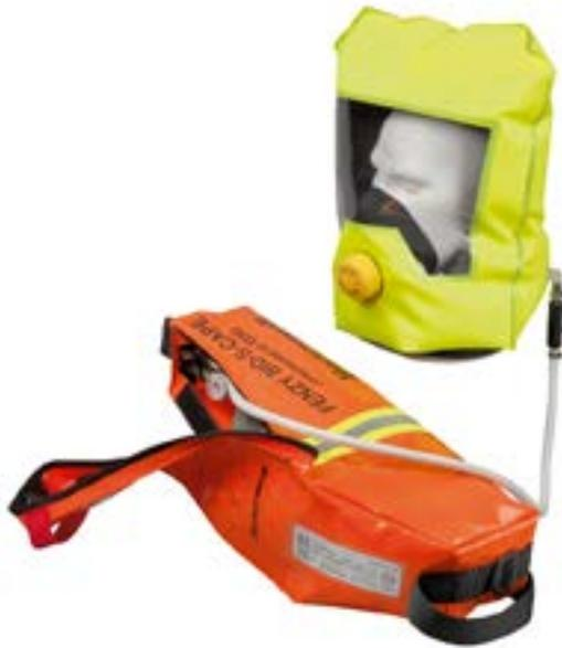
Bio-S-Cape es un equipo ERA de 15 minutos de duración para evacuaciones de emergencia. Regulador activado automáticamente al tirar del asa de la bolsa. Pitido de alarma de fin de suministro (5 minutos). Capucha de alta visibilidad, resistente a la humedad, químicos y temperaturas extremas. Botella de 3 L 200 bar.
